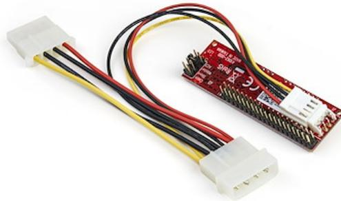
Mit dem 40-poligen IDE-auf-SATA-Adapter IDE2SAT2 können Sie ein SATA I/II/III-Laufwerk an einen verfügbaren IDE/ATA 33/66/100/133-Mainboard-Port anschließen. Mit dieser kostengünstigen Lösung können Sie neuere SATA-Laufwerke hinzufügen und das vorhandene Mainboard behalten.
