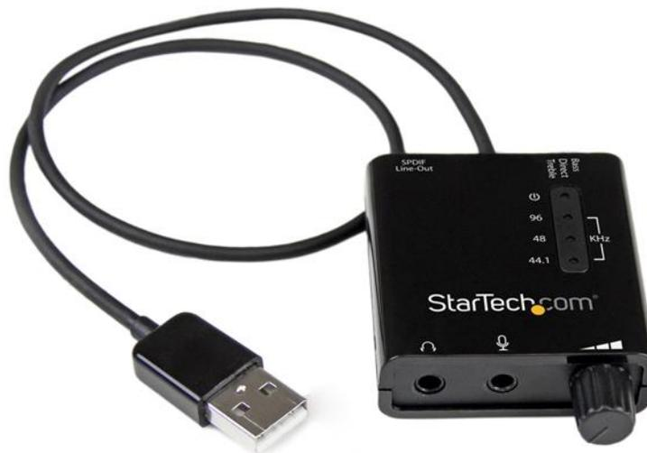
La tarjeta de sonido externa USB, modelo ICUSBAUDIO2D, le permite agregar una salida de audio digital S/PDIF y conexiones de audio/micrófono análogo de 3.5 mm a un sistema a través de USB: una práctica manera de reemplazar el uso de una tarjeta de sonido interna sin tener que abrir la caja de la computadora.
