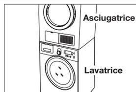
Non spingere l'asciugatrice se montata a colonna sopra la lavatrice. Spingendo l'asciugatrice è possibile schiacciarsi le dita.
