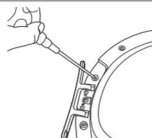
8. Spostare la posizione della vite sul retro della cerniera dello sportello.
