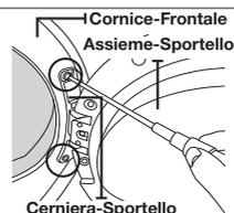
4. Rimuovere le 16 viti presenti. Disassemblare la guarnizione di tenuta e rimuovere le 6 viti previste (3 viti a testa piatta in alto e 3 viti a testa tonda in basso). (Solo per modelli con sportello Crystal Gloss)
