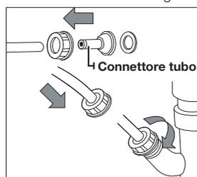
2. Collegare il terminale del tubo allo scarico.
