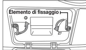
3. Rimuovere il filtro dello scambiatore di calore
