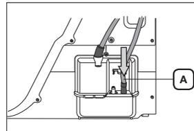
3. Collegare il tubo di scarico accessorio (tubo di scarico lungo) **B** al foro vicino al foro al quale è collegato il tubo di scarico **A**.
