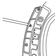
9. Avvitare la vite sul foro inferiore.
