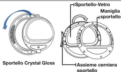
6. Riavvitare le 16 viti fornite nelle nuove posizioni. Riavvitare le 6 viti e sostituire la guarnizione. (Solo per modelli con sportello Crystal Gloss)
