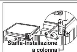
5. Installare l'asciugatrice sulla lavatrice mediante la staffa.
