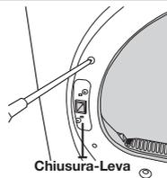
12. Ora, passando sul lato destro del prodotto, serrare le due viti che trattengono la cornice anteriore e le due viti che trattengono la chiusura.
