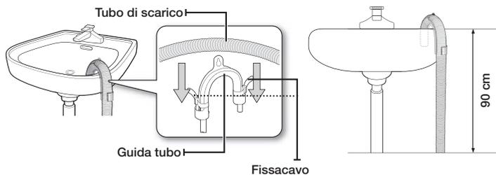
2. Assemblare il tubo di scarico e la guida e fissarli con una fascetta.
