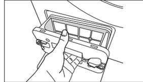
4. Se il filtro dello scambiatore di calore non viene pulito regolarmente, una spia si accende o lampeggia. In questo caso, controllare il filtro dello scambiatore di calore e pulirlo da eventuali lanicci.
