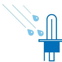
Solo una lampadina realizzata in vetro al quarzo (filamento a 2650 °C, vetro a 800 °C) è in grado di resistere agli sbalzi termici, quando è in funzione: qualora una goccia d'acqua fredda toccasse la lampadina rovente, un'eventualità che può accadere quando guidi sotto la pioggia con un faro rotto.
