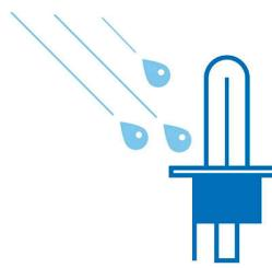
Nur eine brennende Glühlampe aus Quarzglas (Glühfaden 2.650 °C, Glas 800 °C) kann extremen Temperaturschwankungen widerstehen, wenn z. B. ein Tropfen kaltes Wasser auf die heiße Glühlampe fällt.
