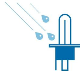
Solo una lampadina realizzata in vetro al quarzo (filamento a 2650 °C, vetro a 800 °C) è in grado di resistere agli sbalzi termici, quando è in funzione: qualora una goccia d'acqua fredda toccasse la lampadina rovente, un'eventualità che può accadere quando guidi sotto la pioggia con un faro rotto.
