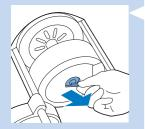
4 Reinigen Sie den Gummieinsatz in der Auslauföffnung im Boden des Wasserbehälters einmal monatlich sowie nach jedem Entkalken.
