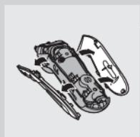
**3** Draai de twee schroeven aan de achterzijde van het scheerapparaat los en verwijder de achterkant van de behuizing.
