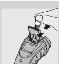
**1** Apague la afeitadora, desenchufe la clavija adaptadora de la red y la clavija del aparato de la afeitadora.
