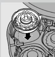
**4** Retirez les têtes de rasoir usées et placez-en de nouvelles dans l'unité de rasage. Remontez le système de fixation et faites-le tourner dans le sens des aiguilles d'une montre.
