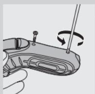
**2** Laat het scheerapparaat lopen tot het stopt, draai de twee schroeven in de haarkamer los en verwijder dit onderdeel.
