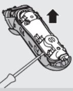
**6** Retirez le panneau arrière du bloc d'alimentation à l'aide d'un tournevis.
