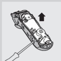
**5** Draai de drie schroeven in de waterdichte voedingsunit los.
