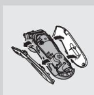
**3** Ôtez les deux vis à l'arrière de l'appareil et retirez le panneau arrière du boîtier.
