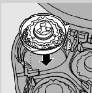
**4** Entnehmen Sie die Scherköpfe, und setzen Sie neue Scherköpfe in die Schereinheit ein. Setzen Sie den Scherkopfhalter wieder in die Schereinheit, und drehen Sie die Verriegelung im Uhrzeigersinn fest.
