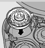
**4** Fjern skjærehodene og sett inn nye i skjæreenheten. Sett holderrammen tilbake i skjæreenheten, og vri låsen med klokken.
