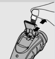
۳ هر شش ماه یکبار، دندانه خط زن را با یک قطره روغن چرخ خیاطی روغن کاری کنید.
