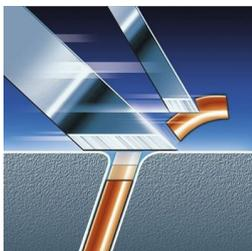
電鬚刀的雙刀鋒系統將鬚髮提起後再刮除，可舒適深層刮鬚。
