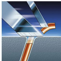
El sistema de doble cuchilla de esta afeitadora eléctrica levanta el pelo para cortarlo por debajo del nivel de la piel.
