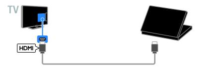
(Solo per alcuni set.) Collegare al televisore il computer tramite un cavo DVI-HDMI e un cavo audio.
