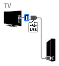
Collegare l'unità flash USB al televisore tramite un cavo USB.
