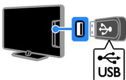
Reliez le disque dur USB au téléviseur à l'aide d'un câble USB.
