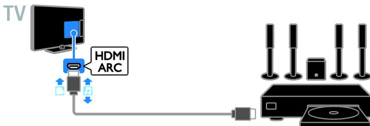
Reliez le système Home Cinéma au téléviseur à l'aide d'un câble HDMI et d'un câble audio optique.
