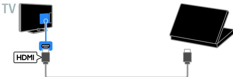
(Pour certains modèles uniquement.) Reliez l'ordinateur au téléviseur à l'aide d'un câble DVI-HDMI et d'un câble audio.
