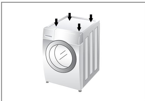
1. Un corretto livellamento della lavatrice serve a impedire che si producano vibrazioni e rumori eccessivi. Installare la macchina su un pavimento ben livellato e compatto, preferibilmente in un angolo della stanza.
