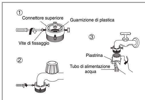
1. Svitare la piastra dell'anello adattatore e le 4 viti di fissaggio dell'adattatore.
