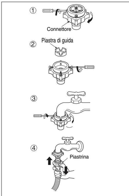
1. Svitare la piastra dell'anello adattatore e le 4 viti di fissaggio dell'adattatore.
