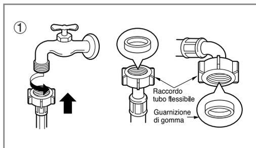
1. Avvitare il connettore del tubo flessibile sul colpetto di approvvigionamento idrico.
