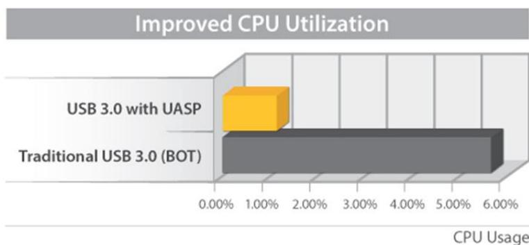
Le test a été effectué avec un système Intel® Ivy Bridge, des cartes contrôleurs USB 3.0 StarTech.com, un boîtier StarTech.com avec UASP et un SSD SATA III.
