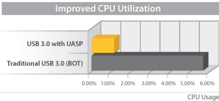
Testergebnisse wurden mit einem Intel® Ivy Bridge-System, USB 3.0-Zusatzkarten von StarTech.com, einem UASP-fähigen StarTech.com-Gehäuse und einem SATA III-Solid State Drive erlangt.
