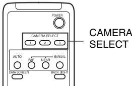
Después, podrá controlar la(s) cámara(s) especificada(s) por su número. Cada vez que controle la(s) cámara(s) con el mando a distancia por infrarrojos, el botón CAMERA SELECT pulsado en el paso 2 se ilumina.
