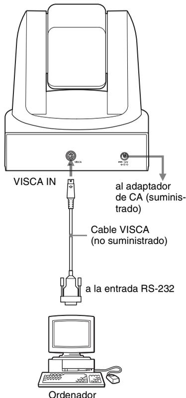
Instalación y conexión
