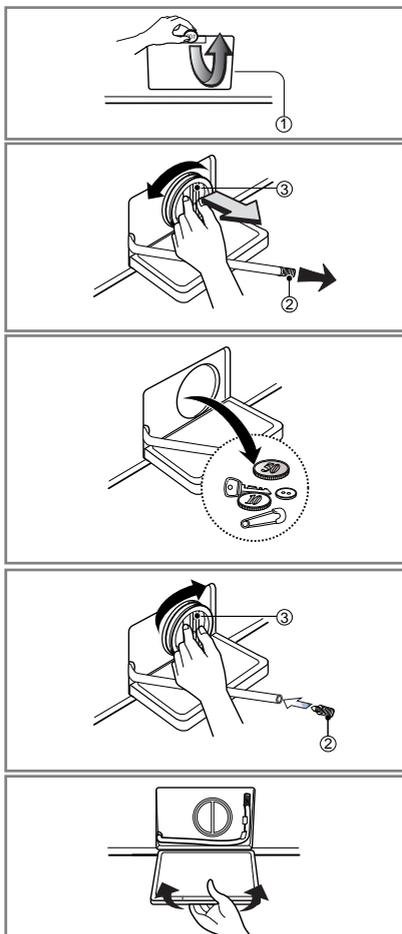
**1.** Aprire il tappo (1) del coperchio inferiore con le dita. Ruotare il tappo di scarico (2) per estrarre il tubo.
