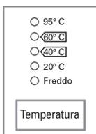
• Ruotando il commutatore di programmazione, si può selezionare la temperatura dell'acqua.
