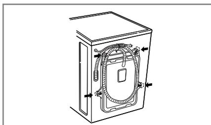
**1.** Per evitare possibili danni interni durante il trasporto, le 4 viti speciali vengono bloccate. Prima di azionare la macchina, rimuovere le viti unitamente ai tappi di gomma.
