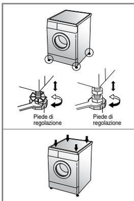
1. Un corretto livellamento della lavatrice serve a impedire che si producano vibrazioni e rumori eccessivi. Installare la macchina su un pavimento ben livellato e compatto, preferibilmente in un angolo della stanza.
