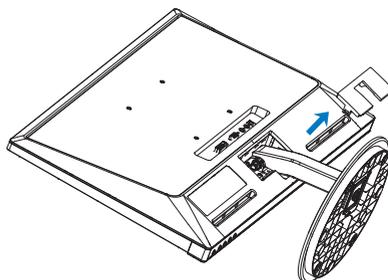
4. Ослабьте четыре винта, чтобы снять колонку.
