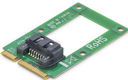
L'adaptateur mSATA vers SATA MSAT2SAT3 vous permet de connecter un disque SATA standard au port mSATA disponible.
