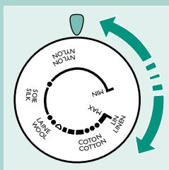
**3** Otáčením nastavte regulátor teploty na doporučenou teplotu.
