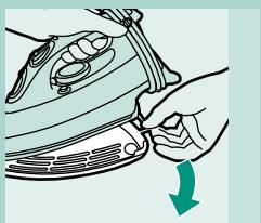
**1** Только для моделей GC4243: удалите защитную теплоизоляционную крышку.
