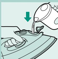
**5** K naplnění zásobníku vodou z vodoudu použijte plnicí nádobku a vodu naplňte až po značku maxima. Zásobník vody nikdy neplňte nad značku MAX.
