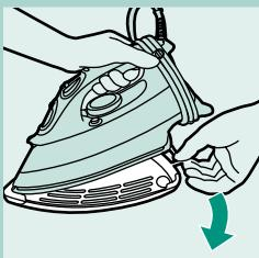
**2** S grijajuće ploče skinite zaštitni pokrov protiv vrućine (samo modeli GC4243). Skinite naljepnice ili zaštitnu foliju s grijajuće ploče.
