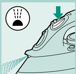
A vízpermet funkció bármely hőfokon alkalmazható a makacs gyűrődések elsimítására.
