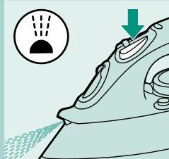
Funkciju raspršivanja možete koristiti za uklanjanje upornih nabora pri bilo kojoj temperaturi.
