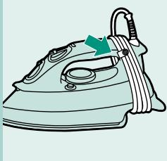
**1** Izvucite mrežni kabel iz utičnice i postavite kontrolu pare na položaj O.
