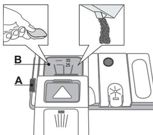
1. Per il dosaggio corretto del detersivo fare riferimento ai dati sopra riportati. La vaschetta **B** contiene indicatori di livello per facilitare il dosaggio del detersivo.
