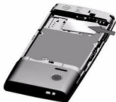
4. 如图示, 将电池上的金属触点与电池槽的金属触点对齐。然后, 将电池推入电池槽, 按下、卡定。
