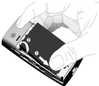
5. 如图示, 将后盖对准槽口推入, 直至卡定到位。
