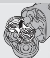
**4** HQ6073/HQ6070: Откройте бритвенный блок, поверните колесико против часовой стрелки (1) и снимите фиксирующую рамку (2).
