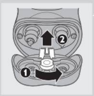
**3** HQ6073/HQ6070: Otevřte holicí jednotku, otočte kolečkem proti směru pohybu hodinových ruček (1) a vyjměte zajišťovací rámeček (2).
