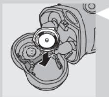
**5** 取出電鬍刀刀頭，然後在電鬍刀組裝上新的刀頭。
