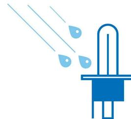
Solo una lámpara encendida fabricada con cristal de cuarzo (filamento a 2650 °C, cristal a 800 °C) puede soportar cambios bruscos de temperatura; por ejemplo, resiste sin explotar el goteo de agua fría sobre el cristal caliente de la lámpara, algo que puede suceder al conducir con una lámpara delantera rota y si hay agua en el entorno.
