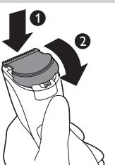
**2** Ubacite ušicu novog rezača u prorez za navođenje (1) i gurnite rezač nazad na aparat (2).
