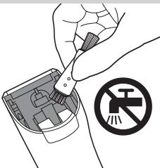
**6** Istrom četkom očistite unutrašnjost aparata.
