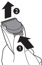
**1** Нажмите кнопку отсоединения (1). Снимите режущий блок с прибора (2).
