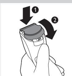
**8** Ubacite ušicu rezača u prorez za navođenje (1) i gurnite rezač nazad na aparat (2).
