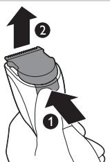
Az elhasználódott, vagy sérült vágóegységet csak eredeti, hivatalos Philips szakszervizben beszerezhető Philips vágóegységgel cserélje.
