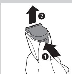
Зношений або пошкоджений ріжучий блок слід замінити лише оригінальними ріжучими блоками Philips, які можна придбати в сервісних центрах, уповноважених Philips.
