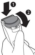
**2** Вставьте выступ на новом режущем блоке в направляющий паз (1) и установите блок на прибор (2).
