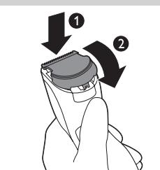
**8** Schieben Sie die Führung der Schneideeinheit in den Schlitz (1), und drücken Sie die Schneideeinheit wieder auf das Gerät (2).
