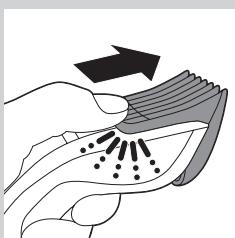
Verwenden Sie den Trimmer ohne den Kammaufsatz, um Haare sehr nah an der Haut abzuschneiden (0,5 mm) oder um die Konturen am Nacken und den Koteletten zu definieren.
