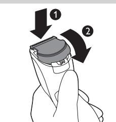
**2** Schieben Sie die Führung der neuen Schneideeinheit in den Schlitz (1), und drücken Sie die Schneideeinheit wieder auf das Gerät (2).
