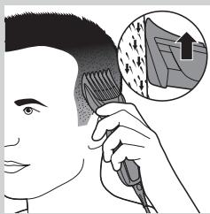
**4** Trimmengaat het beste als u de trimmer tegen de haargroeirichting in beweegt. Zorg ervoor dat de kam steeds in contact blijft met de huid.
