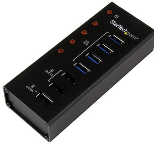
Der USB 3.2 Gen 1-Hub ST4300U3C3 bietet gleichzeitige Daten-Hub- und USB-Ladefunktionen durch Hinzufügen von drei dedizierten USB-Ladeanschlüssen und vier USB 3.2 Gen 1-Datenanschlüssen, also insgesamt sieben Anschlüsse über eine einzige USB 3.2 Gen 1-Host-Verbindung.
