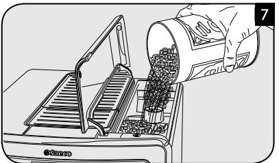
**RO** Vărsați ușor boabele de cafea în compartiment. Repozitionați capacul interior și închideți-l pe cel exterior.
