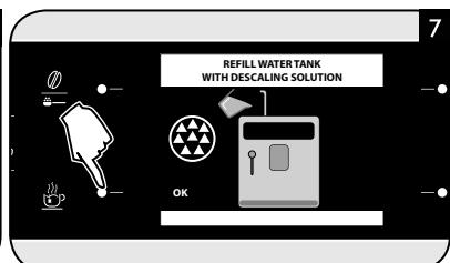
**UA** Знову вставте водяний бачок для води в машину. Натисніть кнопку **OK**.
