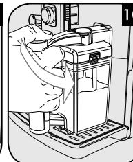
**SL** Pritisnite in obrnite vrč za mleko navzdol, dokler se ne zatakne za pladenj za zbiranje tekočine (zunanji).
