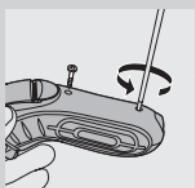
**2** Deje que la afeitadora funcione hasta que se pare, desatornille los dos tornillos de la cámara de recogida del pelo y quitela.
