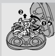
**1** Open de scheerunit, draai de vergrendelknop linksom (1) en verwijder de oplaatplaat (2).
