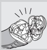
**6** Open de scheerunit opnieuw en laat hem openstaan om het apparaat volledig te laten drogen.
