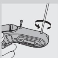
**2** Deixe a máquina de barbear a trabalhar até parar, desaperte os dois parafusos da câmara de recolha dos pêlos e retire-a.
