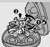
**2** Drücken Sie die Entriegelungstaste, und öffnen Sie die Schereinheit.
