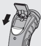
**1** Otevřete zastřihovač zatlačením pojistky směrem dolů.
