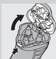
**1** Opreți aparatul, scoateți încărcătorul din priză și fișa din aparat.
