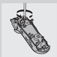
**5** Csatlakoztassa a tömített motoregység három csavarját.
