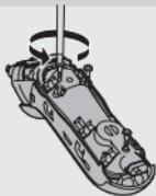
**5** Odkręć trzy śruby modułu zasilającego.
