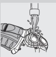
**3** Očistite jedinicu za brijanje i komoru za prikupljanje dlaka ispiranjem topлом vodom iz slavine.
