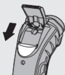
**1 Odprite rezilo s potiskom drsnika navzdol.**
