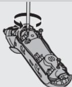
**5** 拧开密封电源部件中的三个螺丝。
