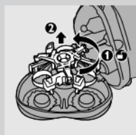
**4** 取下剃须刀头，在剃须刀头部件上装上新刀头。将固定架装回剃须刀头部件，顺时针转动并锁住。
