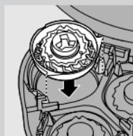
**3 將電鬍刀刀頭裝回電鬍刀組。將固定架裝回電鬍刀組上，並以順時針方向轉動鎖扣。**
