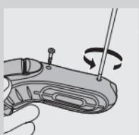
**2** 让剃须刀运转到停止为止, 拧开胡茬储藏室中的两个螺丝, 然后将其取下。
