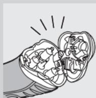
**5 再一次打開電鬍刀組並保持開啟，讓電鬍刀完全晾乾。**
