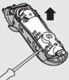
**6** 用螺丝刀将密封电源部件的后面板取下。
