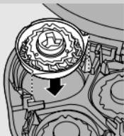
**3** 将剃须刀头放回剃须刀头部件。将固定架放回剃须刀头部件，顺时针转动并锁住。
