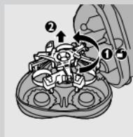
**1** 打开剃须刀头部件，逆时针转动锁 (1)，取下固定架 (2)。
