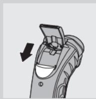
**1** 向下推动滑块，打开修发器。
