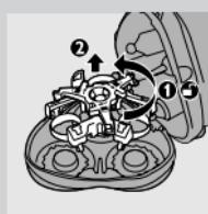
**1 打開電鬍刀組，以逆時針方向轉動鎖扣(1)，並拆下固定架(2)。**
