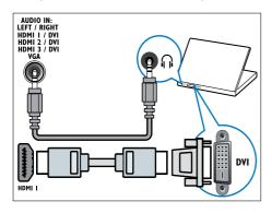
HDMI-Kabel und HDMI-DVI-Adaptor (seitlich HDMI und AUDIO IN L/R)
