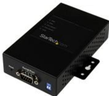
Server dispositivo seriale conforme agli standard del settore, che consente di gestire da remoto un dispositivo seriale RS232/422/485 in una rete LAN o WAN (Local Area Network o Wide Area Network), con ingressi di alimentazione ridondanti e due porte Ethernet da 10/100 Mbps.
