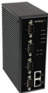
El servidor de dispositivos serie industriales, modelo NETRS42348PD, con 4 puertos y alimentación PoE, permite administrar a distancia hasta cuatro dispositivos serie industriales RS232/422/485 a través de una red local o red de área extensa (LAN/WAN), con alimentación de entrada redundante y doble puerto Ethernet 10/100Mbps.
