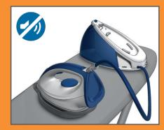
Quando la procedura di rimozione del calcare è completa, il ferro da stiro interrompe l'emissione del segnale acustico.
