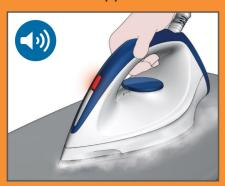
Esegui la rimozione del calcare non appena la spia dedicata lampeggia e l'apparecchio emette la rimozione del calcare non un segnale acustico.
