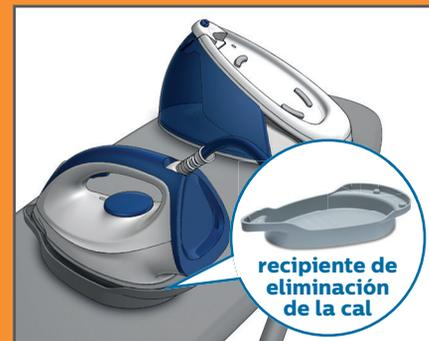
Coloque la plancha sobre el **recipiente de eliminación** de la cal en una superficie uniforme y estable.
