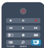
Una vez seleccionado el dispositivo, podrá controlarlo con el mando a distancia del televisor. No obstante, los botones **HOME** y **OPTIONS** y otros botones del televisor no se transmiten al dispositivo.
