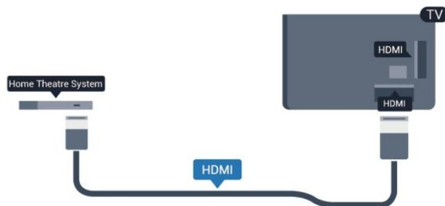
Si el sistema de cine en casa no dispone de conexión HDMI ARC, añade un cable óptico de audio (Toslink) para enviar el sonido de la imagen del televisor al sistema de cine en casa.
