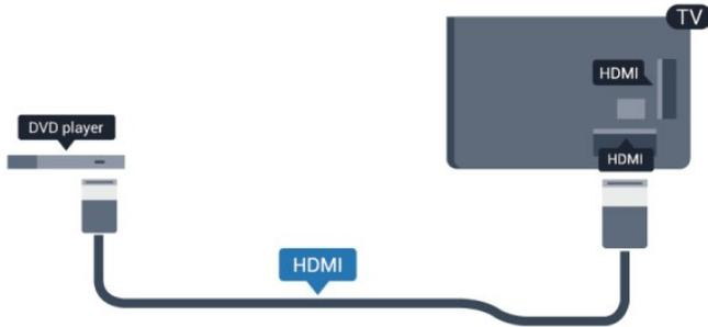
Si el reproductor de DVD está conectado mediante HDMI y dispone de EasyLink CEC, puede controlar el reproductor con el mando a distancia del televisor.
