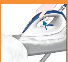
Halten Sie den Dampfauslöser zum Dampfbügeln gedrückt.
