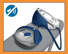
Nach den 2 kurzen Signaltönen ist der Entkalkungsvorgang abgeschlossen.
