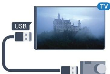
Se l'elenco dei contenuti non viene visualizzato automaticamente, premere **SOURCES** e fare clic su **USB**. Potrebbe essere necessario impostare la fotocamera per trasferire i contenuti tramite PTP (Picture Transfer Protocol). Leggere il manuale dell'utente della fotocamera digitale.
