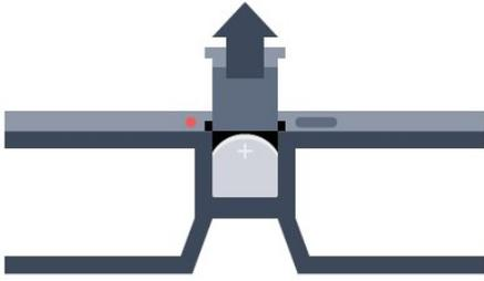
Para sustituir la pila, presione el pequeño saliente de la tapa de la pila y deslice la tapa para abrirla. Sustituya la pila tipo CR2032 (3 V). Asegúrese de que queda visible el lado positivo de la batería. Vuelva a colocar la tapa y deslícela hasta que haga clic.
