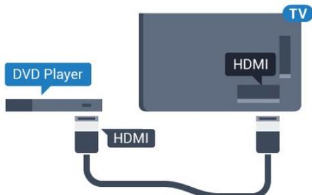
Si el reproductor de DVD está conectado mediante HDMI y dispone de EasyLink CEC, puede controlar el reproductor con el mando a distancia del televisor.
