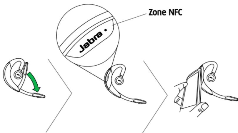
**REMARQUE :** Les périphériques NFC ont leur NFC mise en œuvre de différentes façons. La taille et la sensibilité de la zone NFC, ainsi que le mode de connexion de l'oreillette, peuvent être différents d'un périphérique à l'autre.
