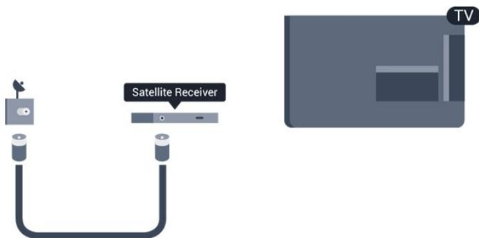
Parallèlement à la connexion de l'antenne, ajoutez un câble HDMI pour connecter le périphérique au téléviseur. Vous pouvez aussi utiliser un câble péritel si le périphérique n'est pas pourvu de prise HDMI.
