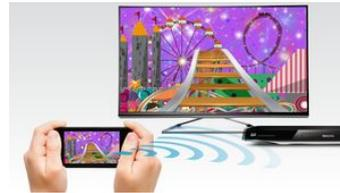
Miracast™ est une norme de transfert de vidéo sans fil utilisant une connexion Wi-Fi Direct. L'interface utilisateur simplifiée permet d'afficher l'écran de l'appareil portable en mode miroir sur un plus grand écran via un appareil certifié Miracast™. Le codec intégré ne limite pas le décodage.
