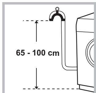
Collegare il tubo di scarico a una condutture di scarico o a uno scarico a muro posti tra 65 e 100 cm da terra evitando assolutamente di piegarlo.
