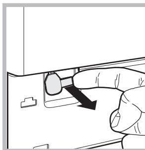
2. verificate che il livello dell'acqua all'interno della macchina sia inferiore rispetto all'apertura dell'oblò; in caso contrario togliere l'acqua in eccedenza attraverso il tubo di scarico raccogliendola in un secchio come indicato in figura.
