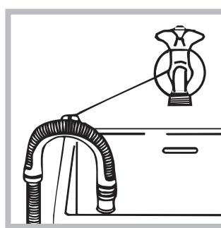
In alternativa, appoggiare il tubo di scarico al bordo di un lavandino o di una vasca, legando la guida in dotazione al rubinetto (*vedi figura*). L'estremità libera del tubo di scarico non deve rimanere immersa nell'acqua.
