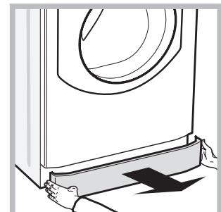
1. Odložte krycí panel na prednej strane zariadenia zatlačením na jeho stred a následným zatlačením smerom nadol z obidvoch strán a potom ho vytiahnite (*vid' obrázky*).
