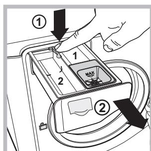
Dávkovač vytiahnete tak, že stlačíte páčku (1) a potiahnete ho smerom von (2) (*vid' obrázok*). Dávkovač umyte pod prúdom vody; toto čistenie je potrebné vykonávať pravidelne.
