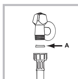
2. Pripojte prívodnú hadicu jej zaskrutkováním ku kohútiku so studenou vodou s hrdom so závitom 3/4" (vid' obrázok). Pred pripojením hadice nechajte vodu odtiečť, až kým nebude číra.
