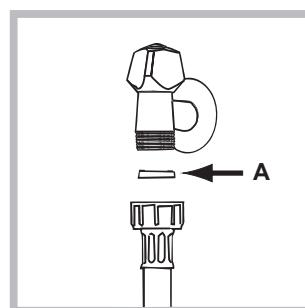
2. Montez le joint A sur l'extrémité du tuyau d'alimentation et vissez-le à un robinet d'eau froide à embout fileté 3/4 gaz (voir figure). Faites couler l'eau jusqu'à ce qu'elle soit limpide et sans impuretés avant de raccorder.
