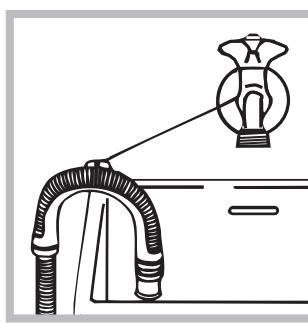
Autrement, accrocher le tuyau de vidange à un évier ou à une baignoire, dans ce cas, fixer le support plastique fourni avec l'appareil au robinet (*voir figure*). L'extrémité libre du tuyau d'évacuation ne doit pas être plongée dans l'eau.
