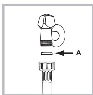
2. Inserire la guarnizione A nell'estremità del tubo di alimentazione e avitarlo a un rubinetto d'acqua fredda con bocca filettata da 3/4 gas (vedi figura).
