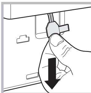
5. remonter le panneau en veillant à bien enfiler les crochets dans les fentes prévues avant de le pousser contre l'appareil.
