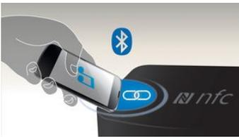
Emparelhe dispositivos Bluetooth facilmente com a tecnologia NFC (Near Field Communication - comunicação por aproximação) de um só toque. Basta tocar com o smartphone ou o tablet com NFC na área NFC de um altifalante para o ligar, iniciar o emparelhamento Bluetooth e iniciar a transmissão de música.
