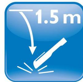
Fallprüfung: 12 Mal freier Fall aus einer Höhe von 1,5 m.
