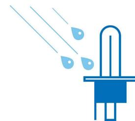
Apenas uma lâmpada acesa fabricada em vidro de quartzo (filamento 2650 °C, vidro 800 °C) pode resistir a choques térmicos: por exemplo, se uma gota de água fria entrar em contacto com a lâmpada quente, o que pode acontecer quando conduz à chuva com um farol partido.
